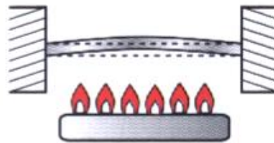
(b) Wysoki współczynnik rozszerzalności \alpha Niski współczynnik rozszerzalności \alpha
