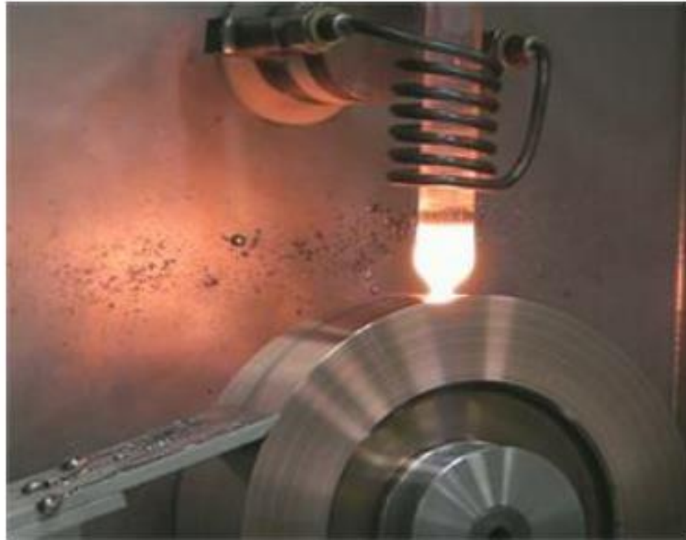
Metoda ciągłego odlewania ciekłego metalu na miedziany walec (ang. Melt spinning)
